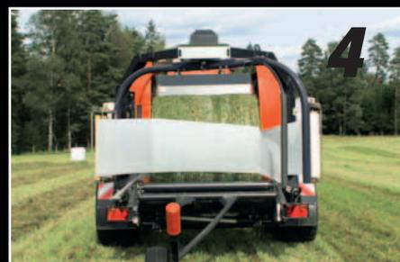
La table termine rapidement sa course en position enfilage et la dépose du film démarre immédiatement.
