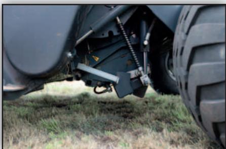
*Le Drop Floor, permet rapidement d'éliminer les bouchages, réduisant ainsi les temps morts pour une productivité maximale.*
