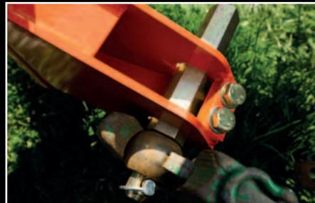
Les axes inférieurs sont réglables en largeur pour adapter la faucheuse à la voie du tracteur.
