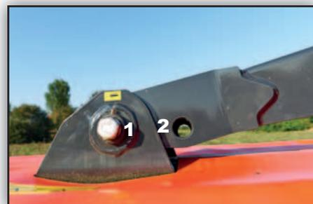
*Unité de coupe avec deux positions afin d'avoir un recouvrement optimal avec une faucheuse frontale.*
