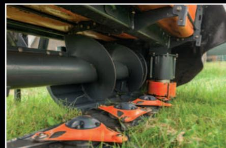
*Dispositif d'andainage actif réalisant des andains structurés.*
