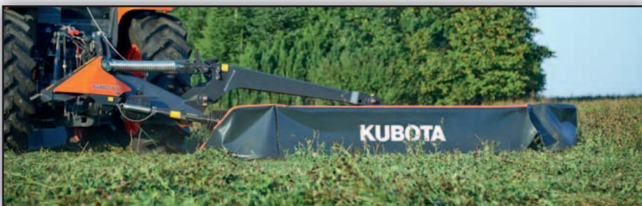
*L'articulation pendulaire permet une adaptation rapide et précise aux différents dénivelés du sol.*
