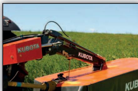
La suspension pendulaire permet une répartition du poids de part et d'autre de la faucheuse uniforme.
