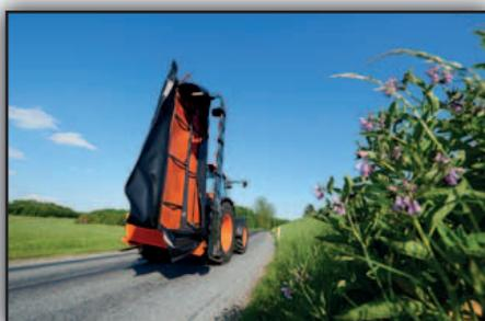
La mise en position transport est hydraulique, actionnée depuis le poste de conduite. La position de transport des DM 2000 est verticale, proche du tracteur, assurant une bonne stabilité, et un confort de conduite idéale.
