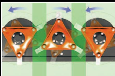
*Les disques à trois couteaux Kubota tournent en sens inverse deux à deux, créant un flux de fourrage régulier.*
