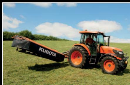
Le relevage en fourrière est assuré par un vérin hydraulique, ne nécessitant pas l'utilisation du relevage.
