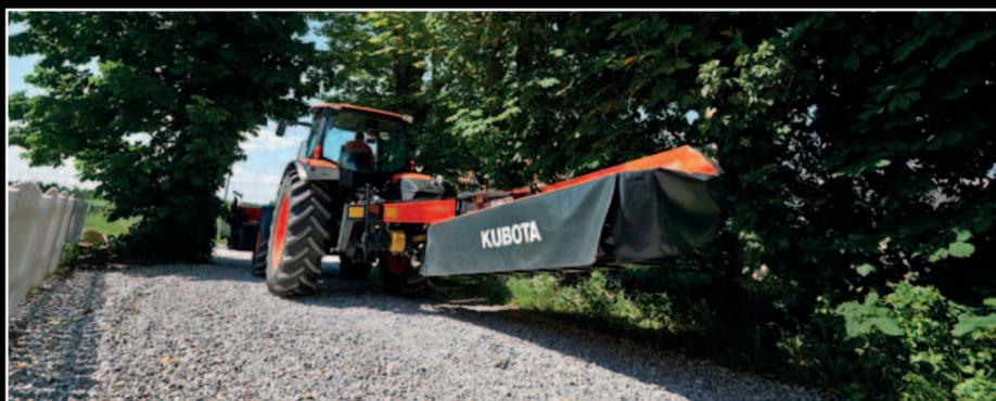
Les DM3300 sont transportées en long derrière le tracteur. La mise en position transport-travail se fait par le biais d'un vérin hydraulique. La largeur au transport est réduite et le remisage est facilité.
