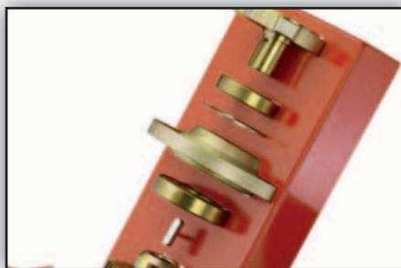
Pour protéger les pignons et le système d'entraînement, Kubota utilise un système de protection par clavette sur chaque disque, qui en cas de surcharge se cisaille.
