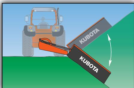
Les modèles Kubota DM2000 ont la possibilité de pivoter de 35° de bas en haut sans aucun ajustement.
