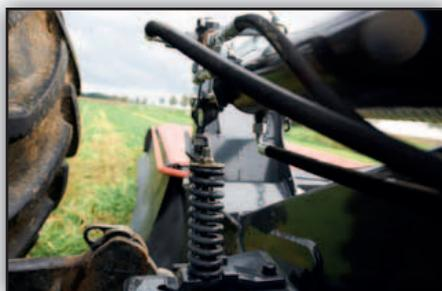
*En cas d'obstacle le dispositif de sécurité Non-Stop protège le lamier.*
