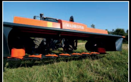
*Accès rapide et facile au lamier grâce aux protections frontales et latérales repliables.*
