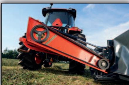
Quatre courroies trapézoïdales assurent une excellente transmission de la puissance.
