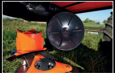
*En standard, la faucheuse est équipée d'un disque d'andainage de chaque côté pour réaliser des andains de 2,20 à 2,40m.*
