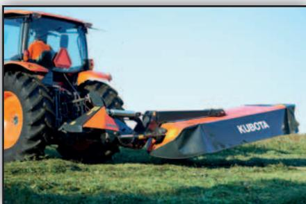
*Le relevage en fourrière s'effectue grâce à un vérin hydraulique tout en offrant une garde au sol importante.*
