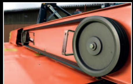
*En inversant le sens des poulies il est possible d'entraîner la faucheuse en 750 ou 1000 tr/min.*
