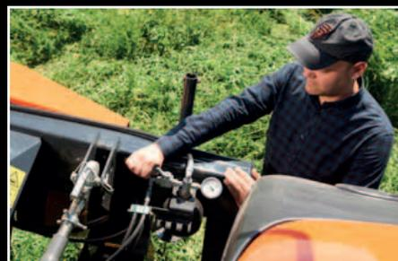
Réglage hydraulique de la pression au sol.
