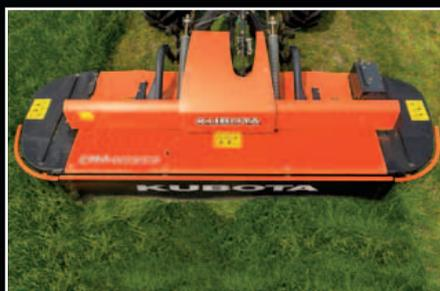
*Un boîtier d'entraînement réversible équipe cette DM4032S. En standard 1000tr/min et par inversion des poulies 750tr/min.*
