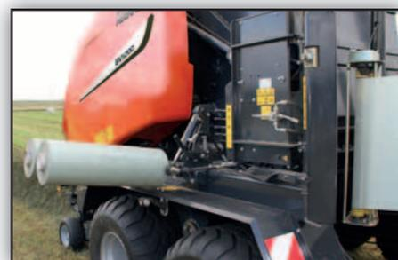
Les magasins de bobines de film sont hydrauliques pour une plus grande aisance.
