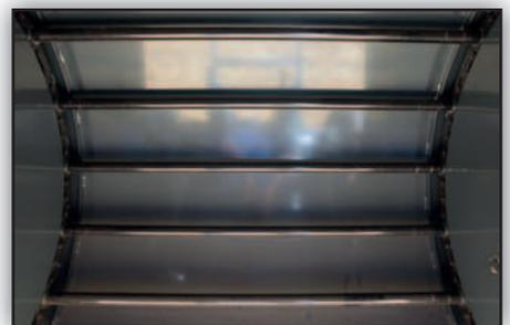
Concept RotaMax ; partie arrière composée de chaînes et barrettes pour une plus grande motricité de la matière.
