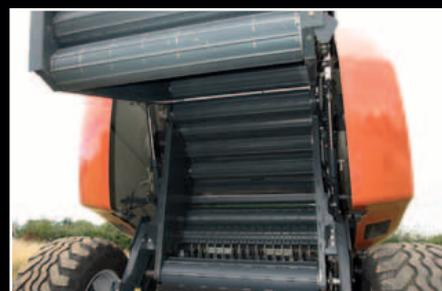
Les rouleaux robustes de la chambre donnent une excellente finition de la balle. Associé au verrouillage mécanique de la chambre ; les Presses BF3250 délivreront une capacité de serrage inégalée.
