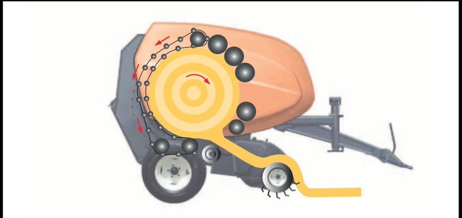
La chambre de pressage des Kubota BF2250 est munie de 5 rouleaux sur la partie avant et de chaînes et barrettes sur la partie arrière. Cette combinaison allie le double avantage d'une excellente motricité de la balle et d'une bonne densité et forme de balle en toutes conditions.
