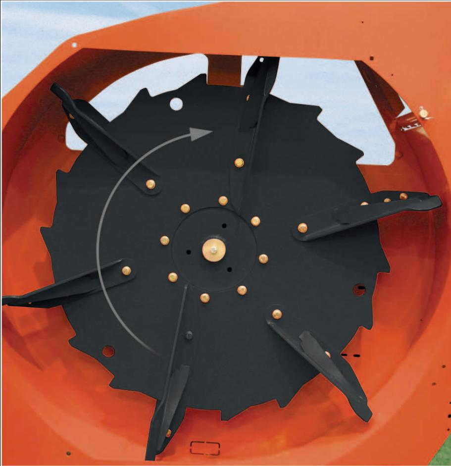
Turbine pour une éjection maximale. Munie de 6 pales d'éjection, la turbine, d'un diamètre de 1,55m, des Kubota série BC, fournit un souffle puissant pour la distribution la plus efficace de matière et un excellent nettoyage de l'enceinte de la turbine.
