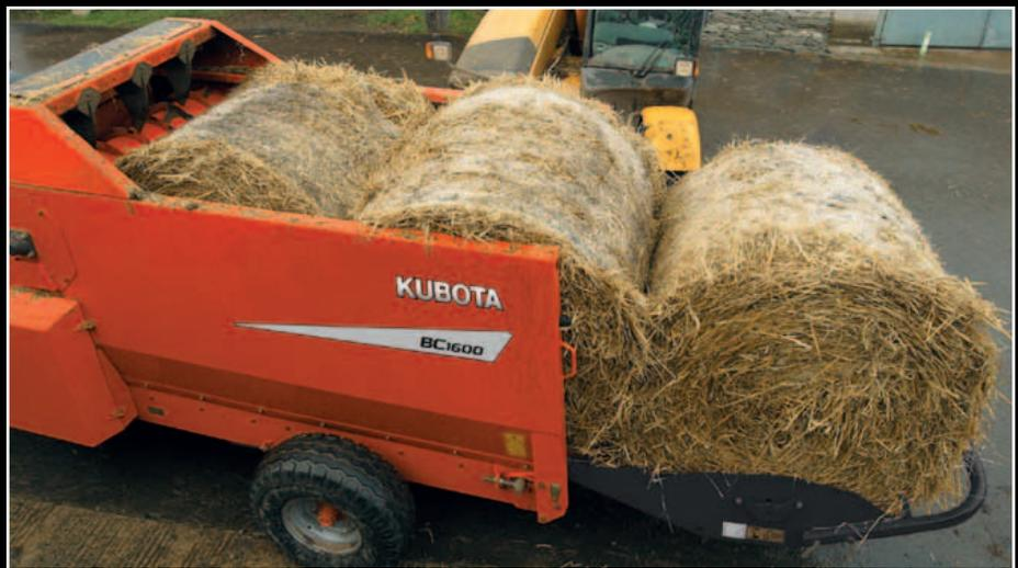
Le chargement multiple de balles rectangulaires ou rondes est possible grâce à la capacité de charge de 6m<sup>3</sup> de la pailleuse Kubota BC1600.
