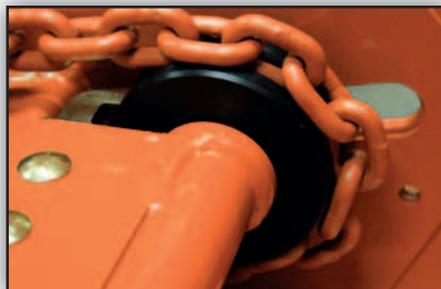
Le convoyeur est guidé par deux bandes d'usures 'UltraGlide' pour une friction réduite et une durée de vie du tablier accrue.
