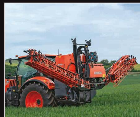
La construction triangulée de la rampe associée aux profilés inférieurs et supérieurs assurent rigidité et robustesse. L'anti-fouettement indépendant des bras de rampe permet une vitesse de travail importante dans toutes les conditions.
