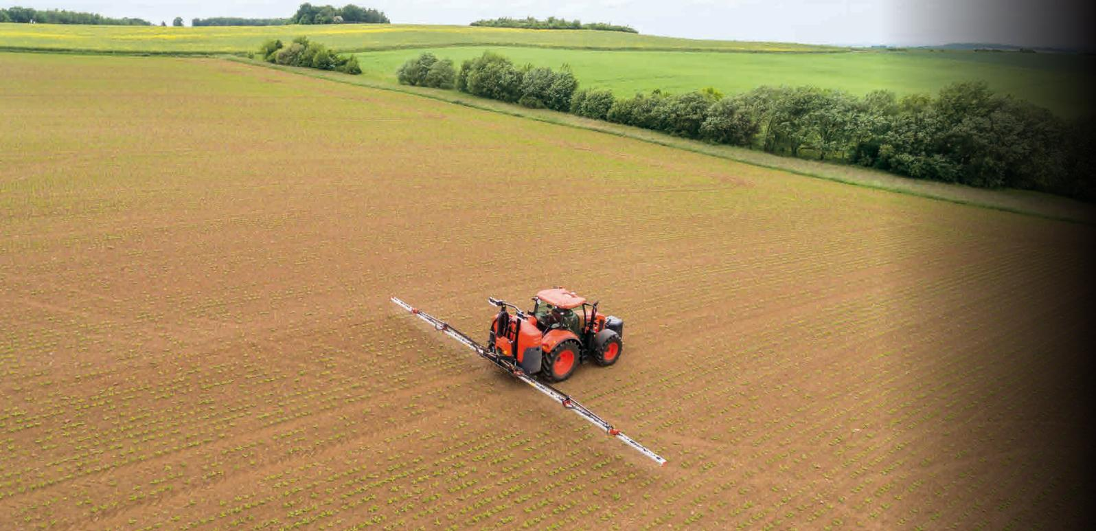
La rampe HOSA est conçue à partir d'un profilé d'aluminium avec un repliage en Z. Ce type de repliage permet de réduire rapidement la largeur pour franchir un obstacle dans le champ. Le profilé d'aluminium est conçu pour une résistance maximum. Aucune soudure ne vient fragiliser la rampe et la protection de surface par anodisation renforce la résistance aux agressions (corrosion, produits phytosanitaires,...).
