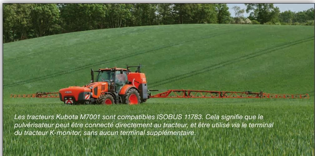
*Les tracteurs Kubota M7001 sont compatibles ISOBUS 11783. Cela signifie que le pulvérisateur peut être connecté directement au tracteur, et être utilisé via le terminal du tracteur K-monitor, sans aucun terminal supplémentaire.*
