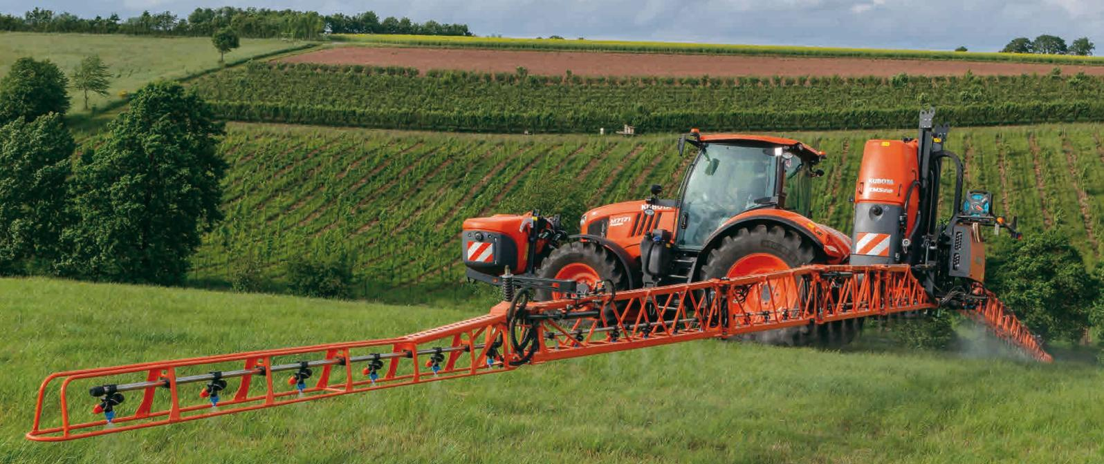
Le Boom Guide est un système de contrôle de hauteur automatique de la rampe, ce système vous aide à maintenir une hauteur de pulvérisation optimale. Les capteurs à ultrason gèrent l'hydraulique du pulvérisateur afin de régler la hauteur de rampe au-dessus de la culture ou du sol. Cette technologie unique procure une excellente stabilité dans toutes les situations, le chauffeur peut rester concentré sur les opérations de pulvérisation.
