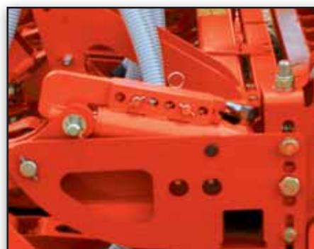
Il existe en plus du système mécanique de série un système de réglage hydraulique que l'on peut commander depuis la cabine du tracteur.
