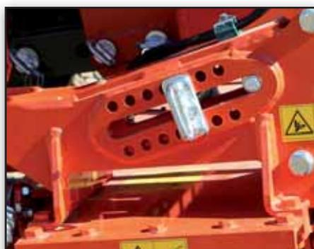
La profondeur de travail de la herse rotative se règle manuellement des deux côtés et assure ainsi une profondeur d'outil et de semis constante.
