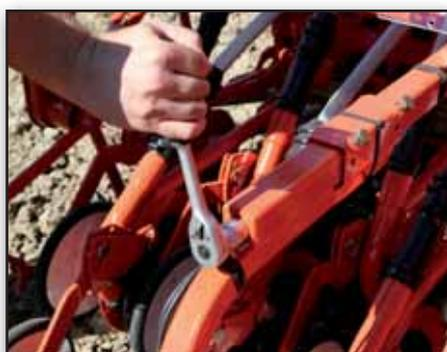
La pression au sol et l'angle de la herse de recouvrement peuvent être réglés manuellement selon les types de sols. Les outils nécessaires font partie de l'équipement standard.
