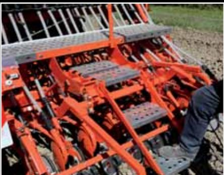
*La marche de chargement et la plate-forme sont de toute sécurité et de tout confort. La marche peut facilement être repliée et bloquée par un axe..*
