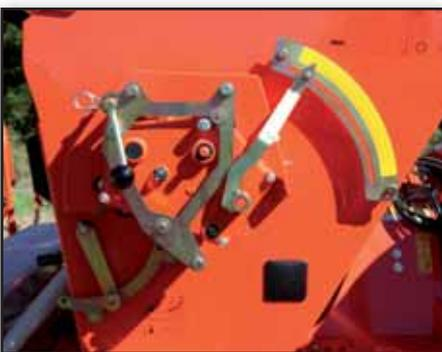
*La boîte de vitesses et le réglage de la densité de semis sont vite accessibles et faciles à manier.*
