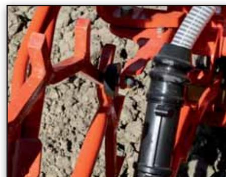
Dès que le semoir est relevé, la roue squelette est immédiatement stoppée par un frein intégré qui empêche la machine de semer en fourrière.
