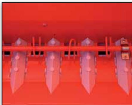
Des conduits dans la trémie assurent le bon cheminement de la semence vers le doseur ainsi qu'un faible volume mort. On a également remédié à la « dispersion » de la semence sur des terrains pentus. La forme spéciale de la trémie permet un travail fiable dans toutes conditions.
