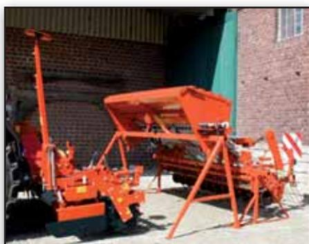
Le MD1000MP se décroche facilement du rouleau et de la herse rotative. Le semoir peut-être déposé en toute sécurité sur ses supports.
