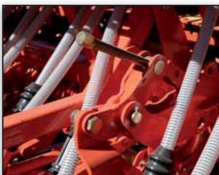
La profondeur des socs est modulée par la commande centrale de pression des socs.
