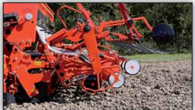
Si la herse rotative doit être utilisée seule, il suffit de relever la barre de semis (seulement avec le système hydraulique). La roue squelette est alors automatiquement placée hors de portée, et l'entraînement des doseurs est interrompu.
