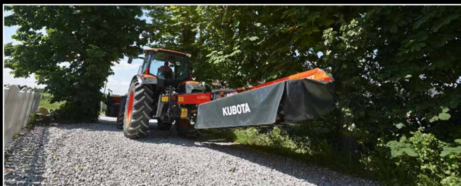
Ces faucheuses sont transportées en long derrière le tracteur. La mise en position transport-travail se fait par le biais d'un vérin hydraulique. La largeur au transport est réduite et le remisage est facilité.
