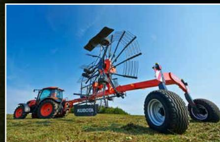
*Équipé en standard d'un essieu auto-directionnel pour une manœuvrabilité exceptionnelle en combinaison avec des roues larges limitant le tassement.*
