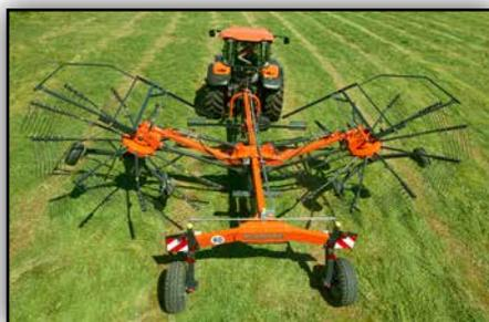
L'ajustement hydraulique des rotors permet un ajustement de la largeur de travail de 7,00m...
