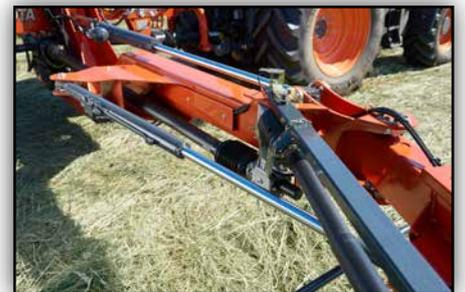
*Suspension hydraulique du bras de relevage avant et le système Non-Stop.*
