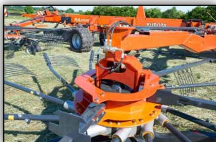
La hauteur de travail de chaque rotor peut être réglée indépendamment et hydrauliquement. De plus, une hauteur minimale peut être ajustée mécaniquement pour garantir un réglage correct.
