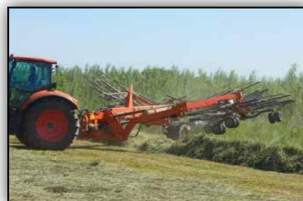
La hauteur de levage importante des rotors assure un dégagement généreux pour les manœuvres en bout de champ. La hauteur de dégagement peut être réglée à l'infini.
