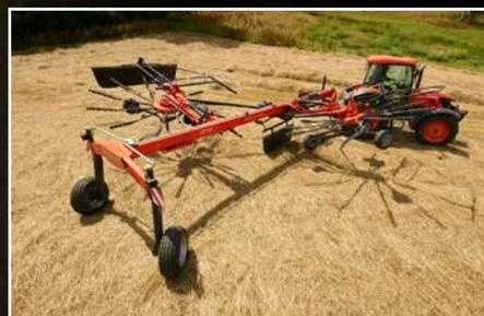
*Le RA2069 est équipé d'une tête pivotante offrant un angle de braquage de 80°, pour une parfaite maniabilité.*
