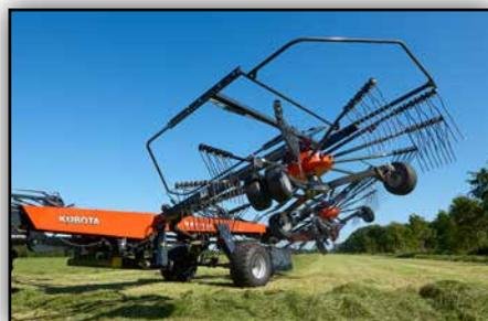
La hauteur de levage importante des rotors assure un dégagement généreux pour les manœuvres en fourrière.
