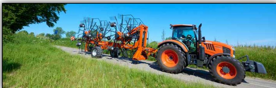
Son système de repliage permet de limiter la hauteur au transport à moins de 4 m, malgré des diamètres de rotors de 3,85 m. Et sans avoir à démonter les bras.
