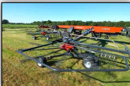
La largeur de travail réglable hydrauliquement de 10,00 à 12,50m. La largeur des andains est également réglable de 1,20 à 1,90m.
