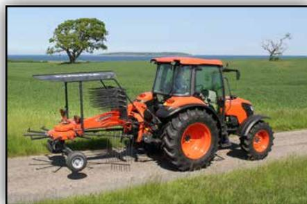
Sur tous nos modèles d'andaineurs, il est possible de réduire la largeur au transport en démontant les bras et en les insérant sur les supports fixés au châssis.
