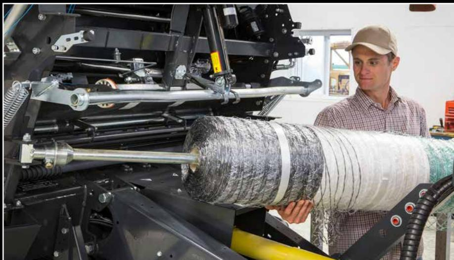
La hauteur de chargement très faible et le passage simplifié du rouleau de filet sont garants d'une perte de temps minimale lors du remplacement du rouleau.
