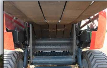
Préchambre mixte à noyau froissé, combinaison de 3 rouleaux et de 5 courroies pour des départs de balles instantanés.
