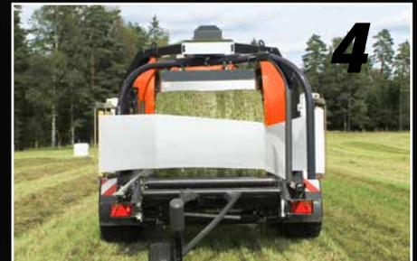
*La table termine rapidement sa course en position enfilage et la dépose du film démarre immédiatement.*
