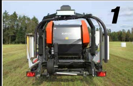
*Lors du temps de liage, la table d'enfilage vient se positionner sous la presse.*
