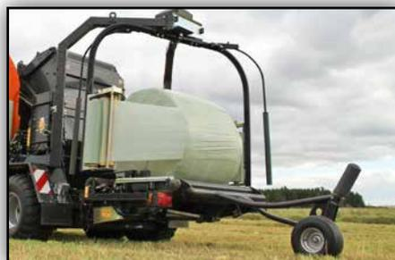
Enfilmeuse double satellite munie de 4 courroies sans fin pour un enrubannage rapide et régulier de grande qualité.
