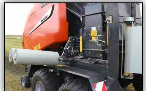
Le stockage de bobines de film sont hydrauliques pour une plus grande aisance.
