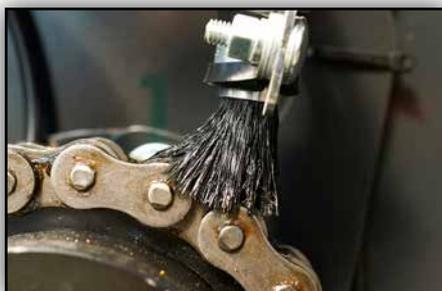
*Lubrification automatique des chaînes en standard activée en permanence, avec un débit pré-réglé chaîne par chaîne.*
