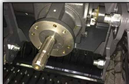
*Boîtier double sortie sur les presses équipées du rotor. Assurant une répartition idéale de la puissance, réduisant l'usure et les besoins en puissance.*
