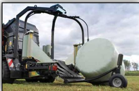
*Vire-balle disponible en option. Au transport, le kit est automatiquement transféré à l'intérieur du châssis pour plus de sécurité.*
