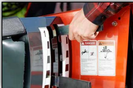
L'extrémité avant et arrière de la tôle de conditionneur est réglée indépendamment.
