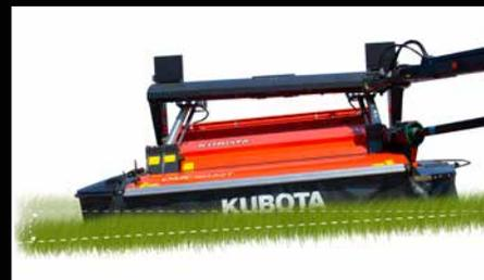
*La suspension à ressorts assure une adaptation parfaite aux dénivelés du terrain.*
