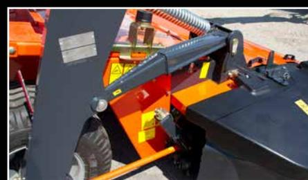
*En cas d'obstacle, la faucheuse recule tout en montant pour esquiver l'obstacle et revient automatiquement en position travail une fois celui-ci passé.*
