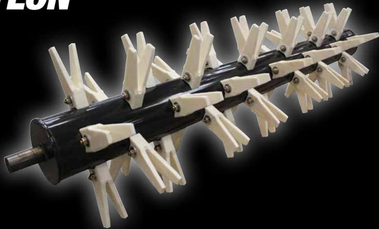
Aux systèmes de conditionnement existant Kubota, vient s'ajouter le conditionneur à doigts nylon. Les doigts nylon sont très rigides, mais durables, et se déformeront sans rupture s'ils rencontrent un obstacle. C'est une solution idéale lorsque vous travaillez dans des conditions vallonnées ou avec des tracteurs plus petits, car le poids des doigts en nylon est inférieur à celui des dents en acier traditionnelles.
