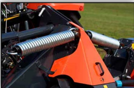
*Ressorts de suspension de large section, réglables hydrauliquement, en option.*
