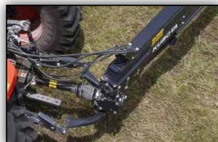
*La tête pivotante offre un confort optimal lors des manœuvres en fourrière.*
