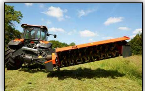
*Relevage hydraulique intégré pour faciliter le relevage en bout de champ.*
