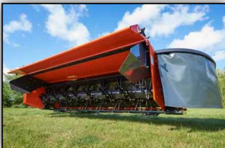
Le passage de l'andainage à l'épandage large s'effectue en une minute montre en main. Les volets d'andainage s'escamotent facilement sur le côté, le système d'épandage large FlipOver se tourne de 180°. Aucun outil n'est nécessaire.
