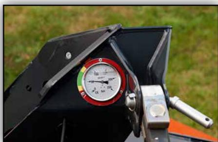
La pression au sol se règle facilement depuis le siège du tracteur, grâce à un dispositif hydraulique qui inclut une échelle graduée facile à lire sur la faucheuse pour une vraie aide à la conduite.
