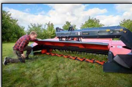
L'accès au lamier est aisé et rapide, facilitant l'inspection quotidienne des disques et des couteaux.
