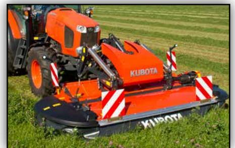
*Ressorts de suspension placés à l'avant pour une plus grande stabilité et une pression au sol constante.*
