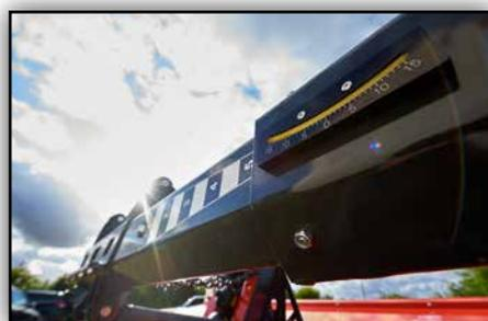
Montage et réglage simples - Mise à niveau facile du bras de suspension pour contrer toute inclinaison latérale du tracteur.
