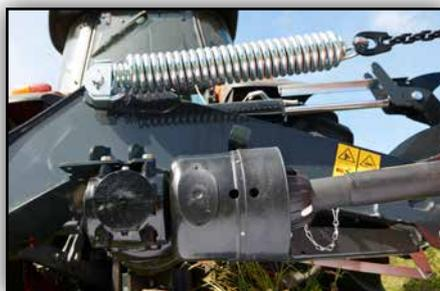
*2 vitesses de rotation – Il suffit juste de tourner de 180° le boîtier d'entraînement.*
