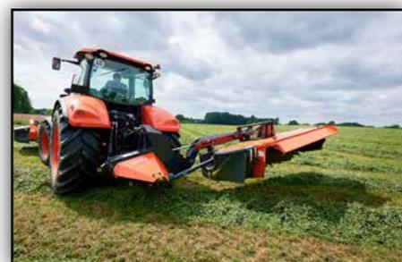
*Distance minimale de 500 mm par rapport au sol, des unités de fauche lors des manœuvres en fourrière. L'unité de fauche est levée et le bras porteur incliné de 10°.*
