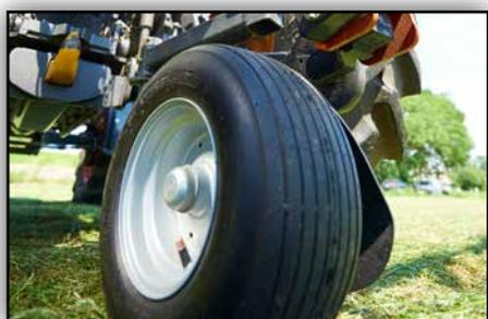
Toutes les faneuses peuvent être dotées d'une roue de jauge pour une parfaite stabilité derrière le tracteur.
