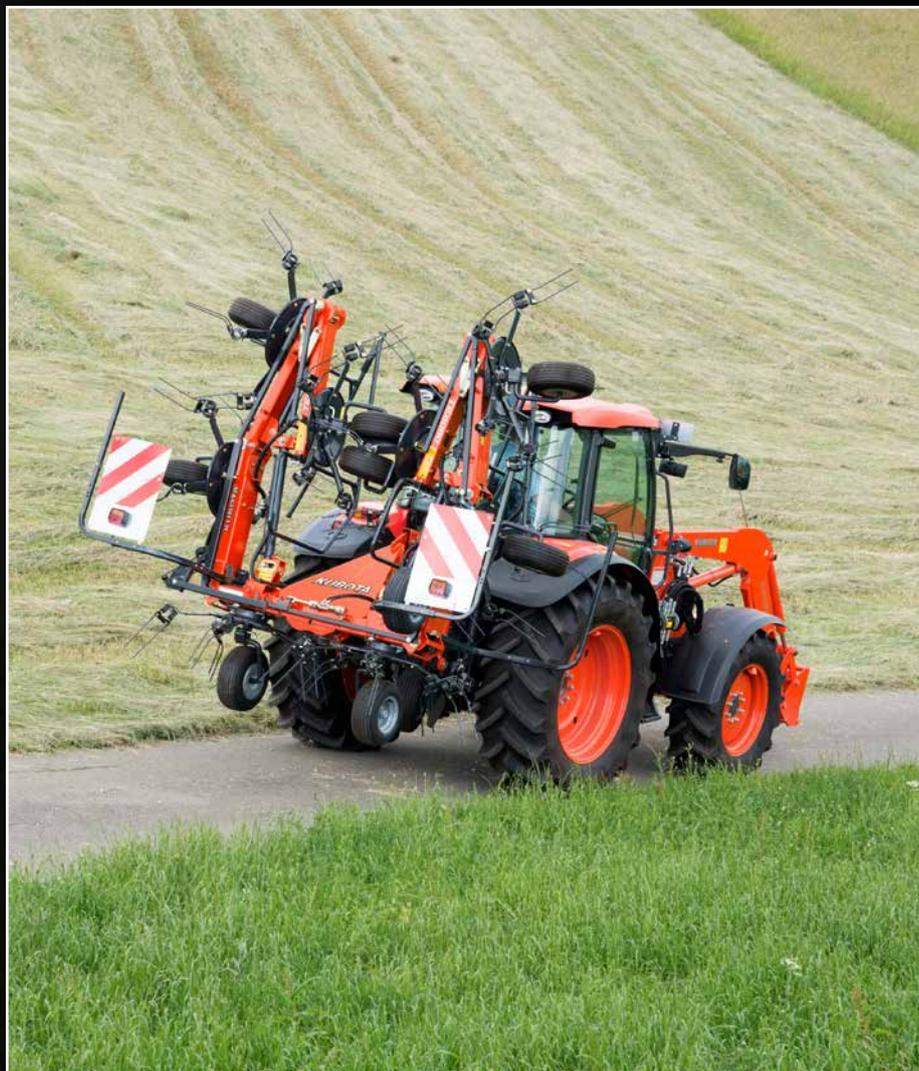
La TE8080 se replie au transport en position compacte.
