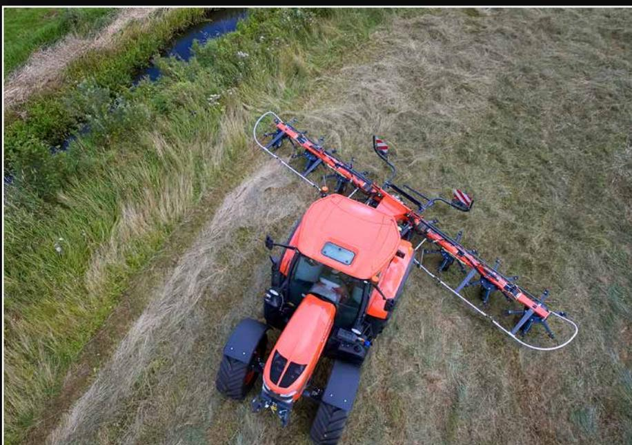
Maintenez votre fourrage à l'intérieur du champ grâce au dispositif de mise en oblique centralisé, qui permet de dégager les bordures. Un indicateur permet de visualiser la position de la faneuse.
