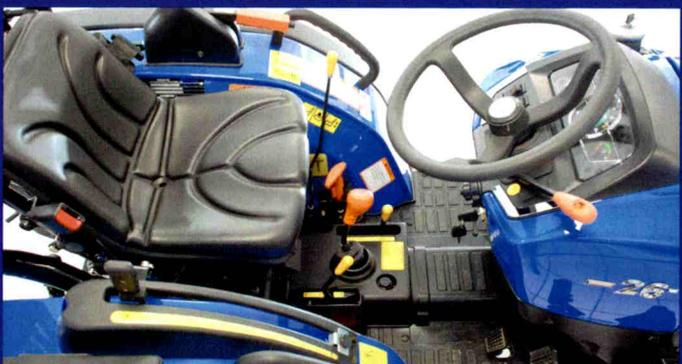
Plate-forme de pilotage spacieuse et confortable avec toutes les commandes à portée de main. Arceau et ceinture de sécurité de série.
