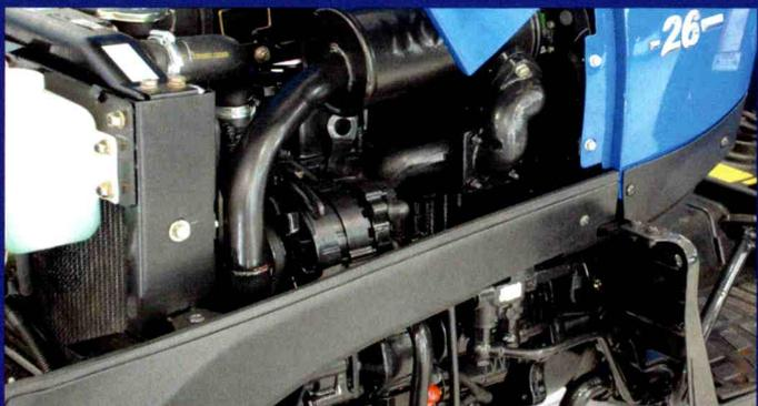
Puissant moteur diesel Mistubishi 3 cylindres, 1318 cm<sup>3</sup> pour une puissance réelle de 24 CV et 18 Kw.
