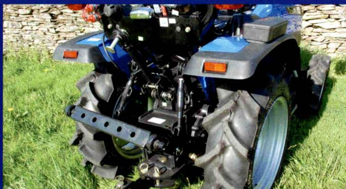
Tout est d'origine : arceau de sécurité, barre à trous, crochet d'attelage AV et AR, distributeur hydraulique double effet, prise remorque, feux de travail AR, gyrophare, contrepoids AV.
