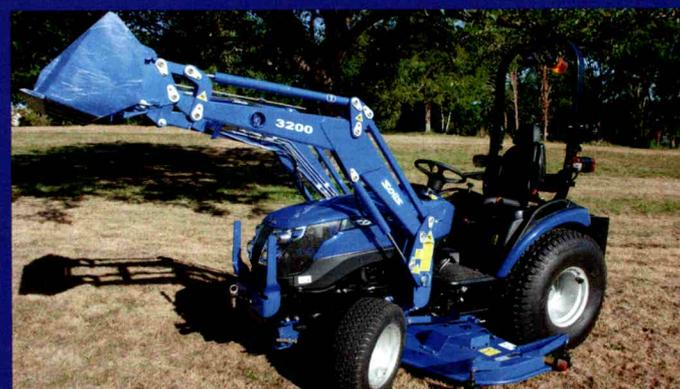
Option chargeur frontal, tondeuse ventrale avec relevage hydraulique, roue gazon, agraire, mixte.
